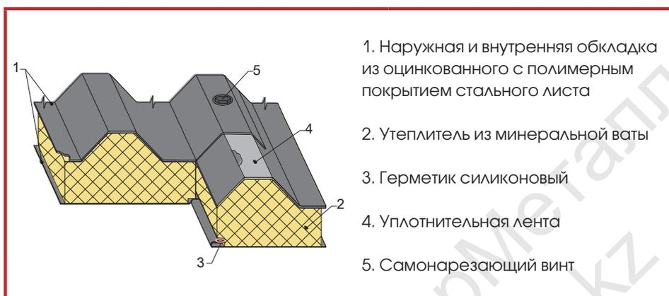
Схема крепления кровельных панелей к несущей конструкции
