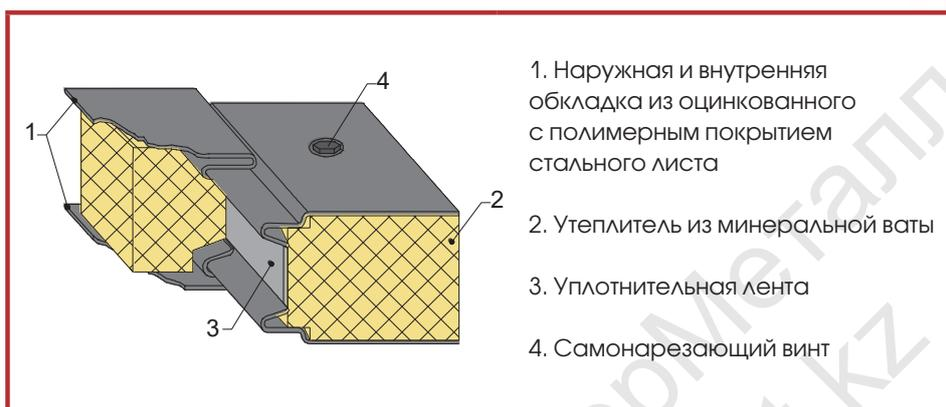
Схема крепления стеновых панелей к несущей конструкции
